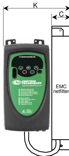
EMC netfilter geplaatst naast de Commander SK
